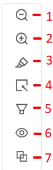
Рисунок. Панель инструментов (1 и 2 – лупа (уменьшить/увеличить); 3 – подсветка связей; 4 – фильтр слоёв; 5 – фильтр связей; 6 – режим отрисовки ER – модели; 7 – макет)
